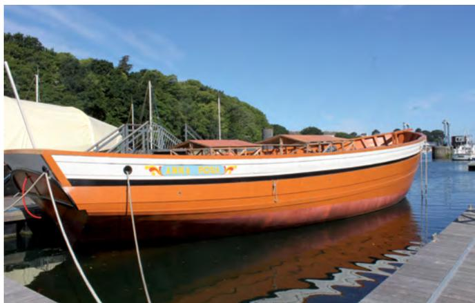
Le caboteur norvégien *Anna-Rosa* construit en 1893 en Norvège a subi une importante restauration de la coque et du pont au chantier Tanguy de 2011 à 2014. L'équipe technique du Port-musée réalise la suite du chantier : les aménagements intérieurs, le gréement et les superstructures, afin que le navire soit à nouveau ouvert au public au mois de juin 2016.
